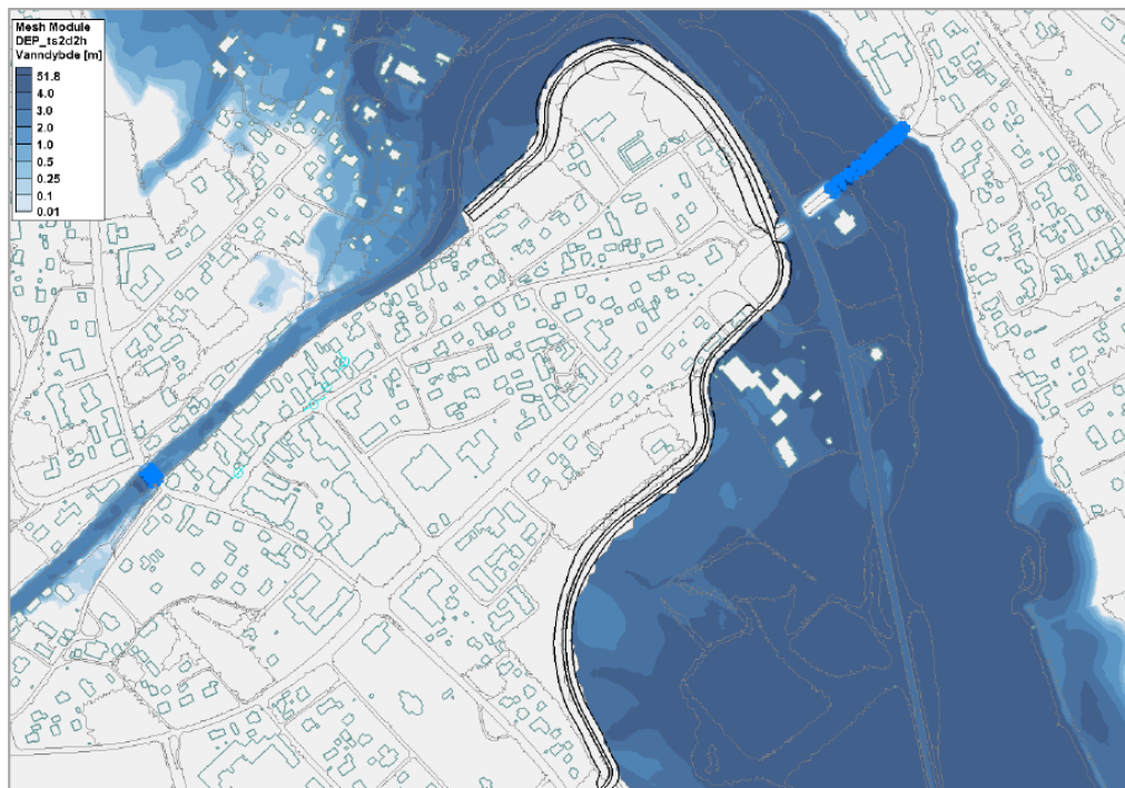
Figur 98. Flomareal og vanddybder (m) rundt Nesflata for 200-årsflom med klimapåslag, etter tiltak. Flomvoll slik denne lå ute ved 1.gangs høring/offentlig ettersyn er vist med sort strek. Kilde: Dr. Blasy – Dr. Øverland Ingenieure GmbH
