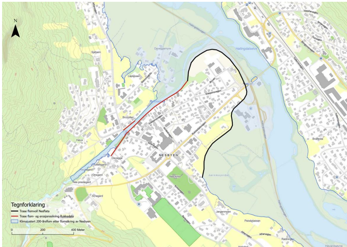
Figur 6. Valgt løsning for flomvoll på Nesflata som ligger til grunn for detaljreguleringsplanen, sammenstilt med flom- og erosjonssikring langs Rukkedøla. Kilde: Rapporten Alternativer flomreduserende tiltak - samlerapport , NVE, 09.03.2026
