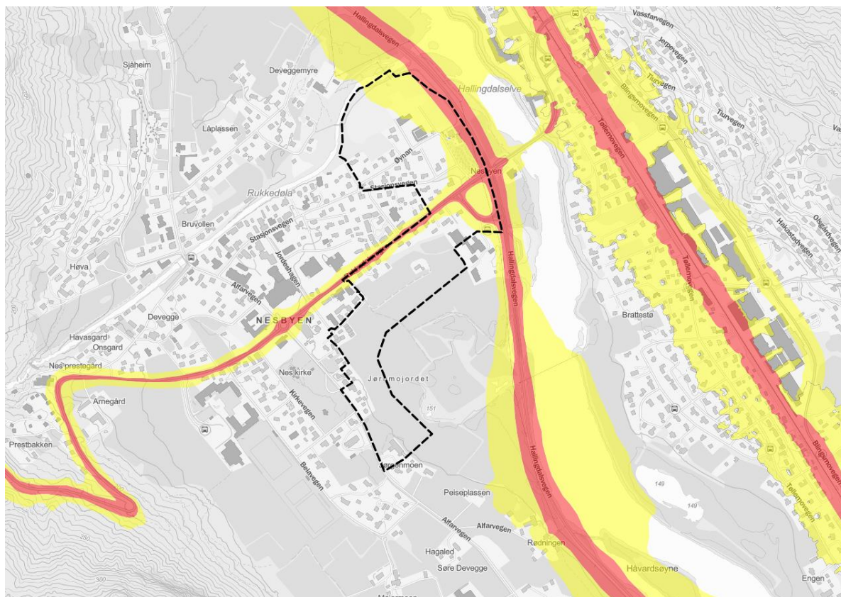
Figur 46. Støysonekart for dagens situasjon. Rød sone viser støy med L_{den} > 65 dB, gul støysone viser støy med L_{den} > 55 dB. Planområdet er vist med sort, stiplet strek. Kilde: Naturbasekart
