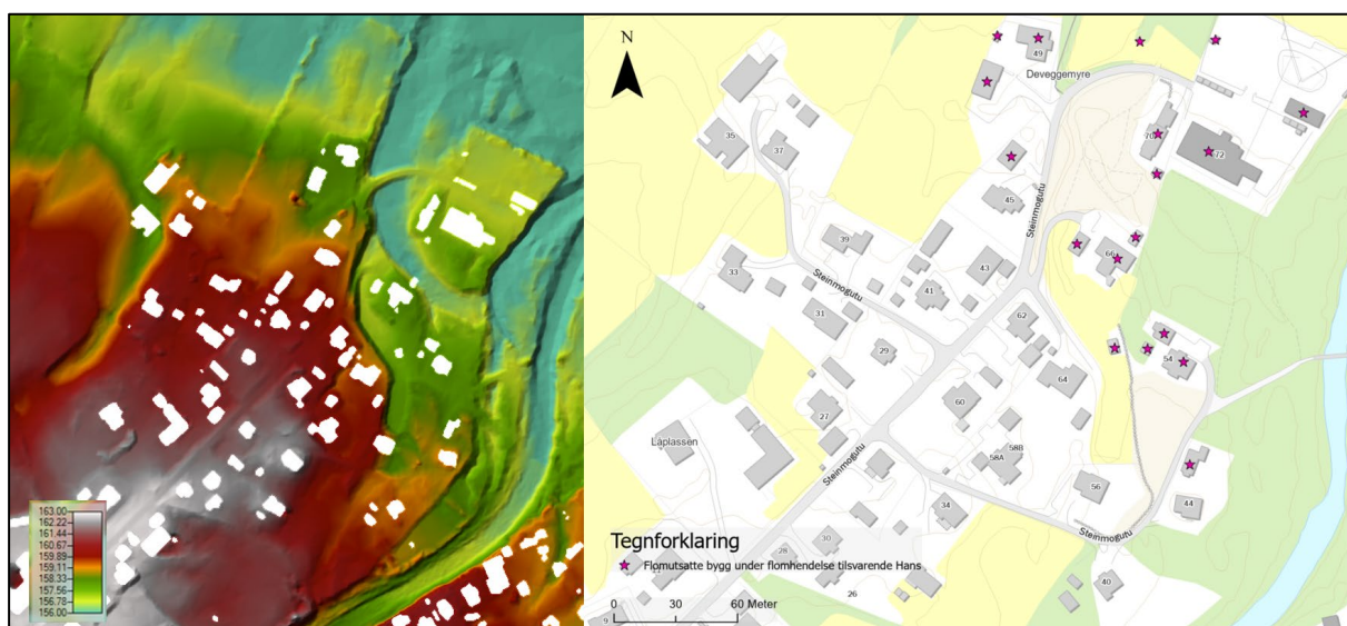
Figur 3. Terrengflata ved Steinmogutu til venstre og flomutsatte bygg ved flomhendelse tilsvarende ekstremværet Hans
