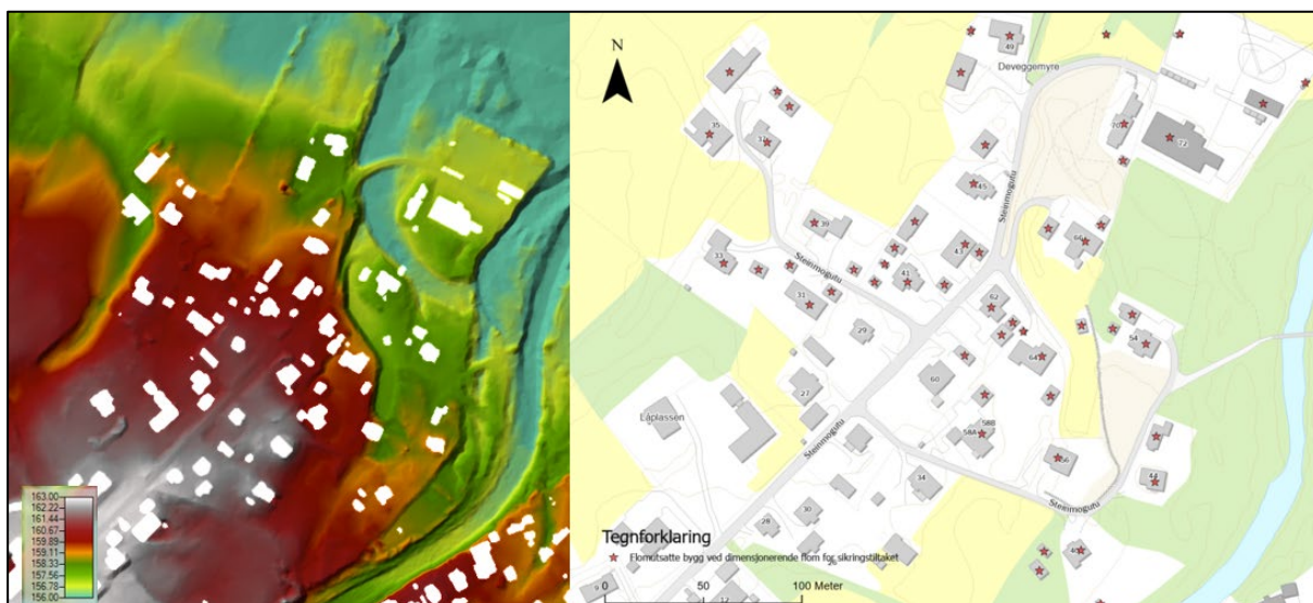
Figur 2. Terrengflata ved Steinmogutu til venstre og flomutsatte bygg ved dimensjonerende flom for sikringstiltaket.
