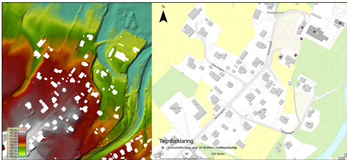
Figur 5. Terrengflata ved Steinmogutu til venstre og flomutsatte bygg ved 20-årsflom i Hallingsdalselva
