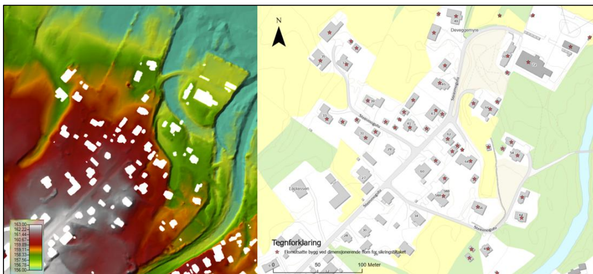
Figur 3. Terrengflata ved Steinmogutu til venstre og flomutsatte bygg ved dimensjonerende flom for sikringstiltaket.
