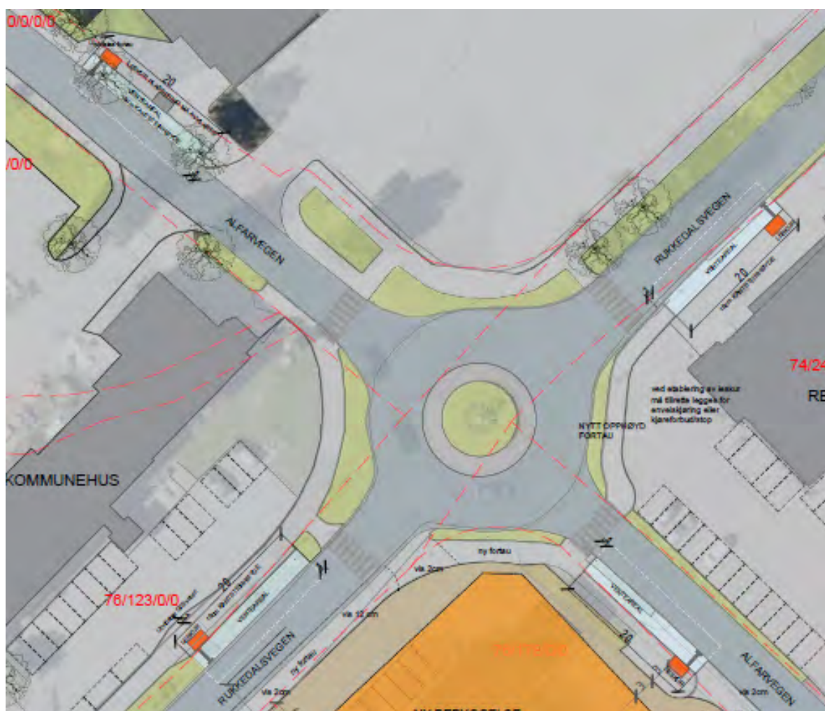
Figur 26. Foreslått knutepunkt-løsning med kantstopp og venteareal (Sør Arkitekter). Kantstopp markert med lys stiplede strek, venteareal med lyseblå farge og leskur med oransje farge.
