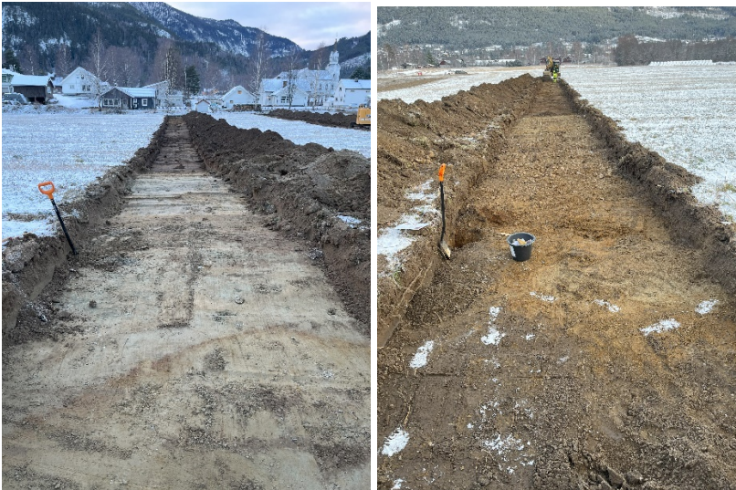
Figur 6. Stor variasjon i B-sjiktets tekstur (kornfordeling). Til venstre: Ensartet silt i nesten hele sjakta. Til høyre: Veksling mellom silt-partier og partier med grus og stein i B-sjiktet.
