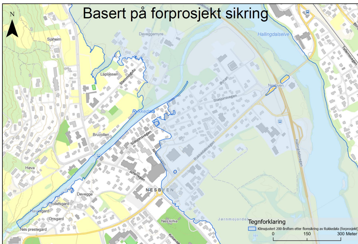
Figur 22 Flomsone for 200-årsflom inkludert klimapåslag dersom Rukkedøla sikres mot flom. I figuren er ikke Hallingdalselva sikret. Flomsone dersom Rukkedøla og Nesflata sikres vises i Forprosjekt for Nesflata (LISAS 2025a)
