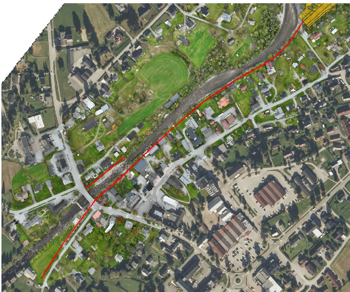
Figur 10 Utstrekning av sikringstiltaket langs sørsiden av Rukkedøla. Flomvollen på Nesflata ses lengst oppe til høyre på kartene.
