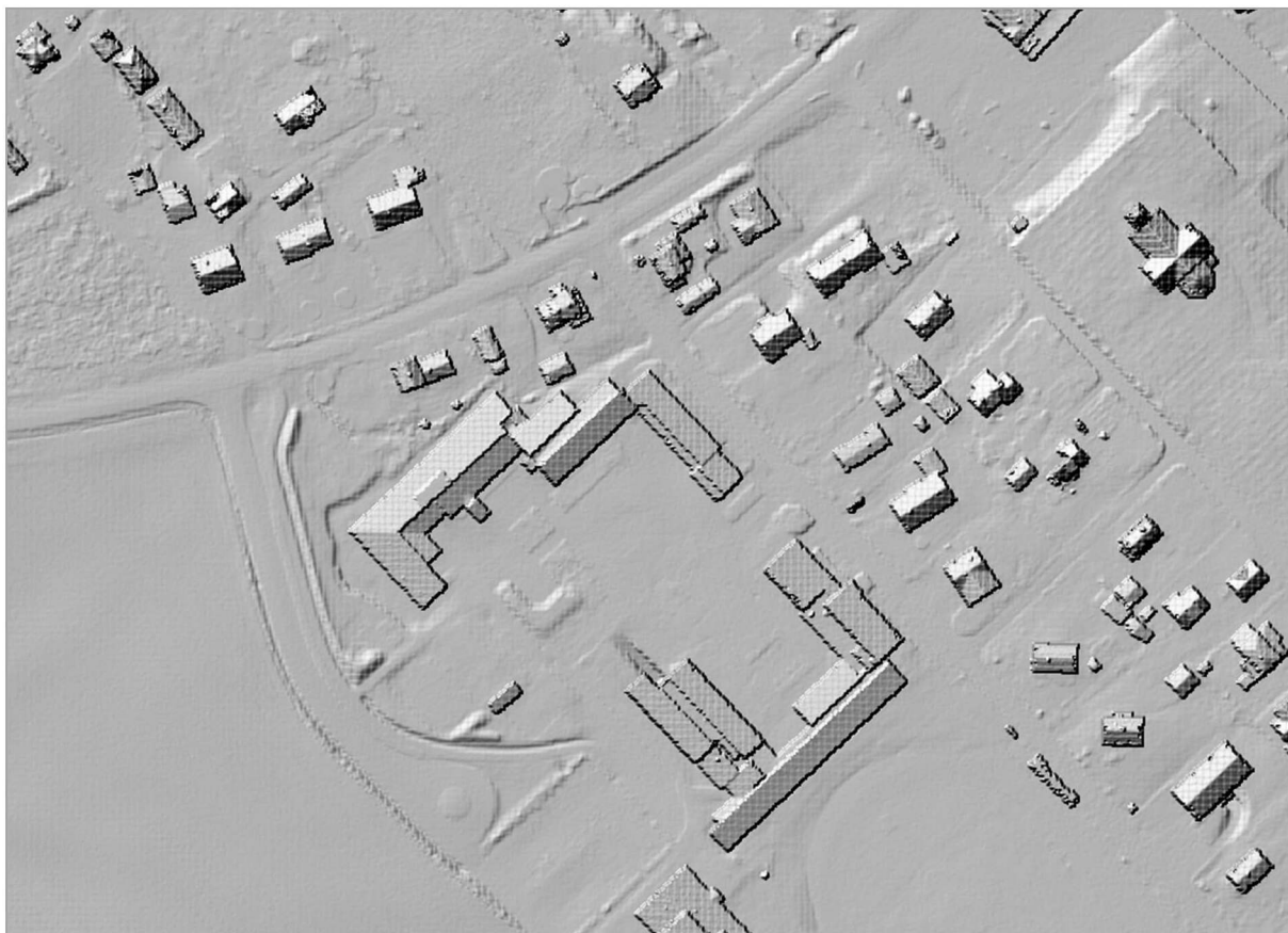
Figur 3.2 Utklipp av den digitale terrengmodellen med modellerte bygninger
