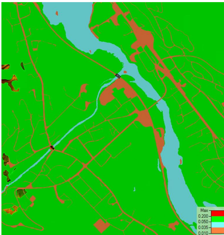
Figur 10: De kalibrerte ruhetstallene (Manning's n ) brukt til modellering.
