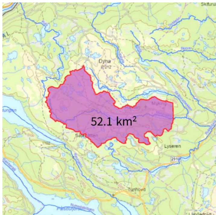
Figur 17: Nedbørfelt ved utløp til Mykingsjøen
