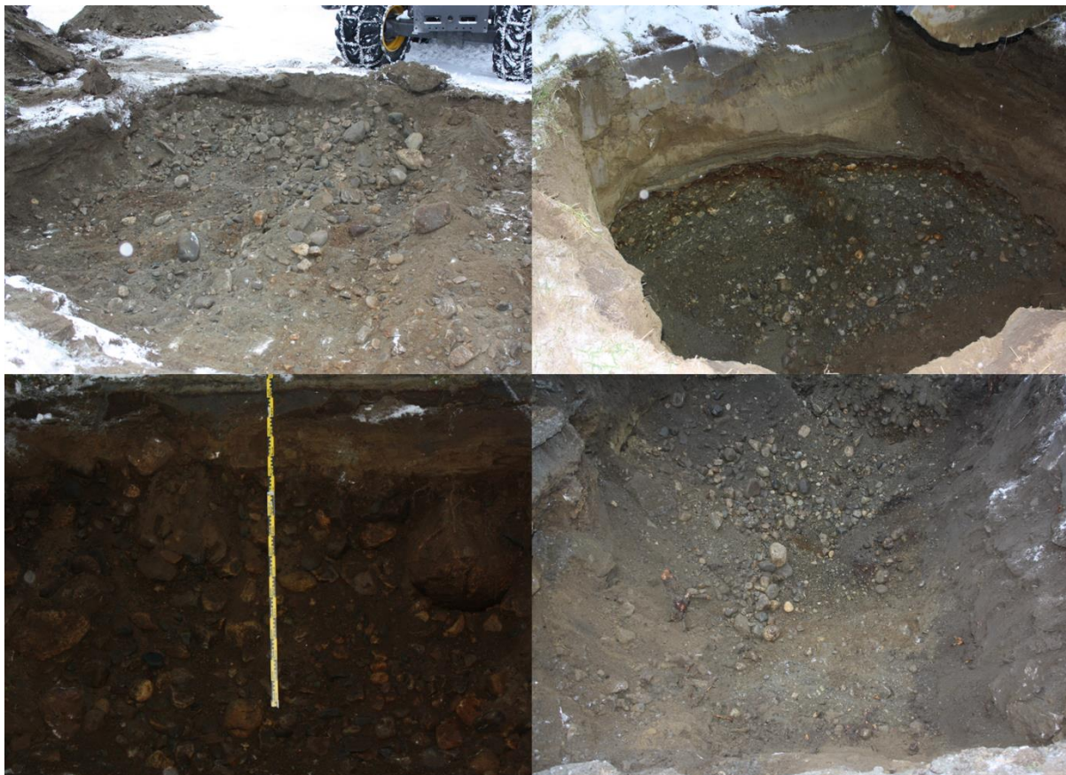
Figur 21: Bilder av løsmasser fra prøvesjaktning ved 4 lokasjoner
