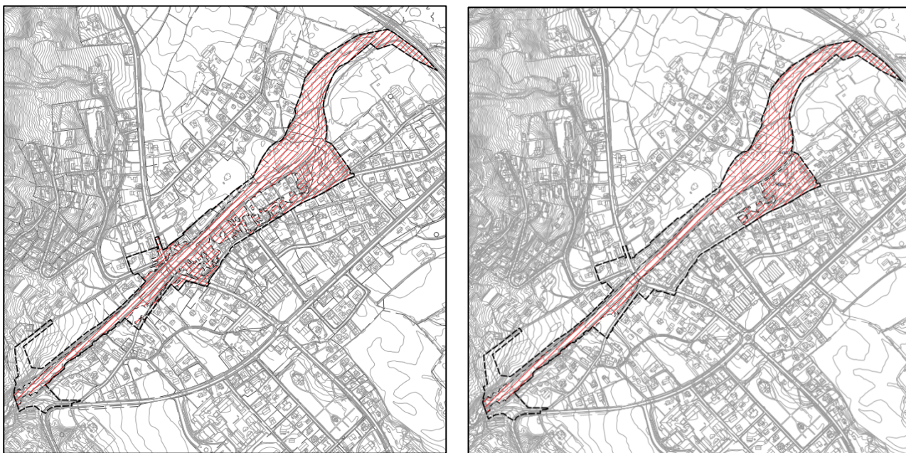
Figur 40. Kartet til venstre viser dagens potensielle flomsone for 200-årsflom med klimapåslag angitt som H320_1 i plankartet og kartet til høyre viser potensiell flomfare etter flom- og erosjonssikringstiltak langs Rukkedøla angitt som H320_2 i plankartet, uten flomvollen på Nesflata.
