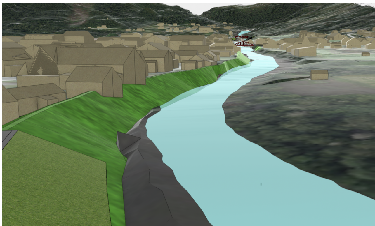
Figur 45 viser flom- og erosjonssikringstiltaket i Rukkedøla sett fra flomvollen på Nesflata.
