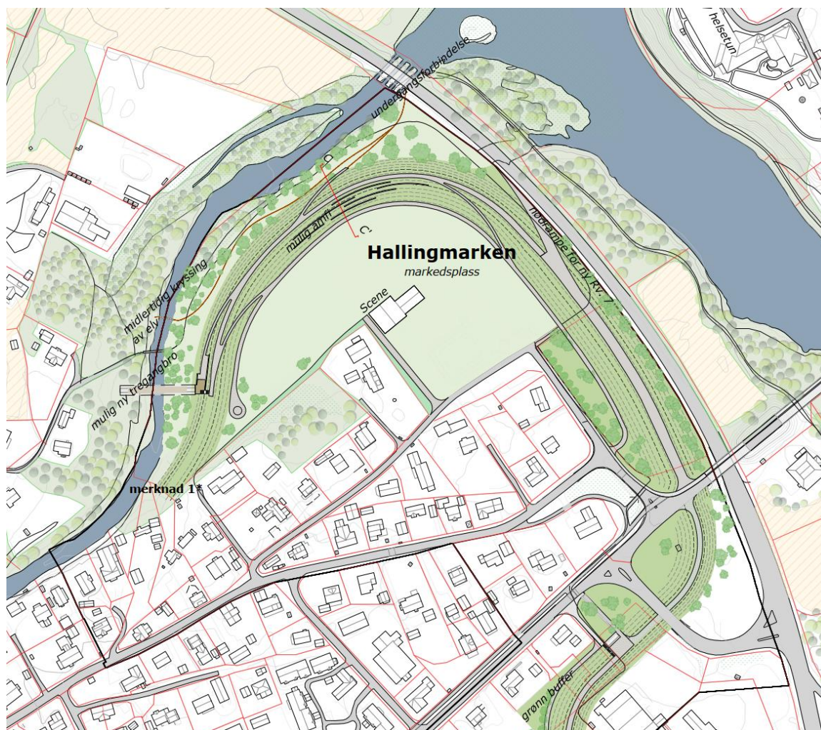
Figur 56. Utsnitt fra illustrasjonsplan som viser flomvoll ved Hallingmarken. Kilde: Rambøll
