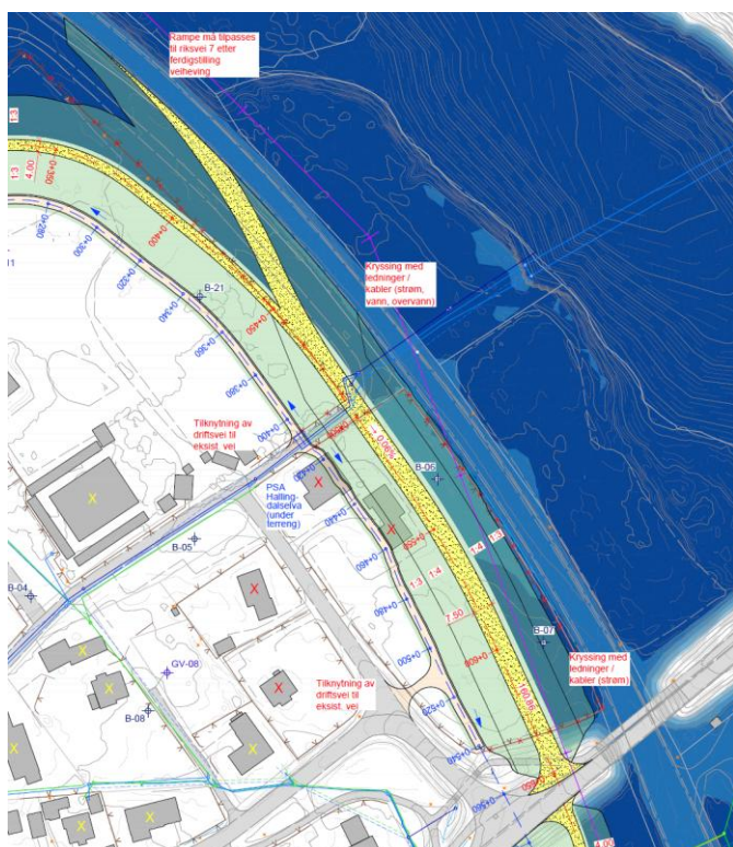
Figur 51. Strekning hvor flomvollen er planlagt kombinert med nødrampe til/fra Rv. 7, for bruk under flomhendelser. Utsnitt fra situasjonsplan, kilde: Dr. Blasy - Dr. Øverland Ingenieure GmbH. Tilkobling til Rv. 7 vil detaljeres senere av Statens Vegvesen.
