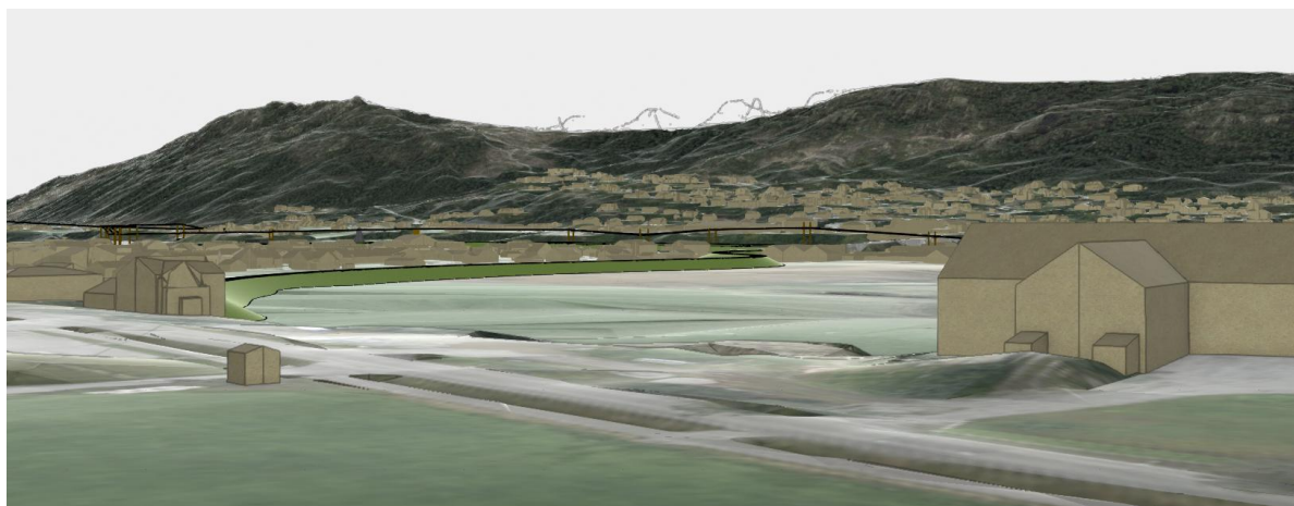
Figur 77. Utsnitt fra 3D-modell som viser flomvollen i mørkt grønt. Sett fra adkomsten ved Jørgenmoen/Alfarvegen, mot nordøst
