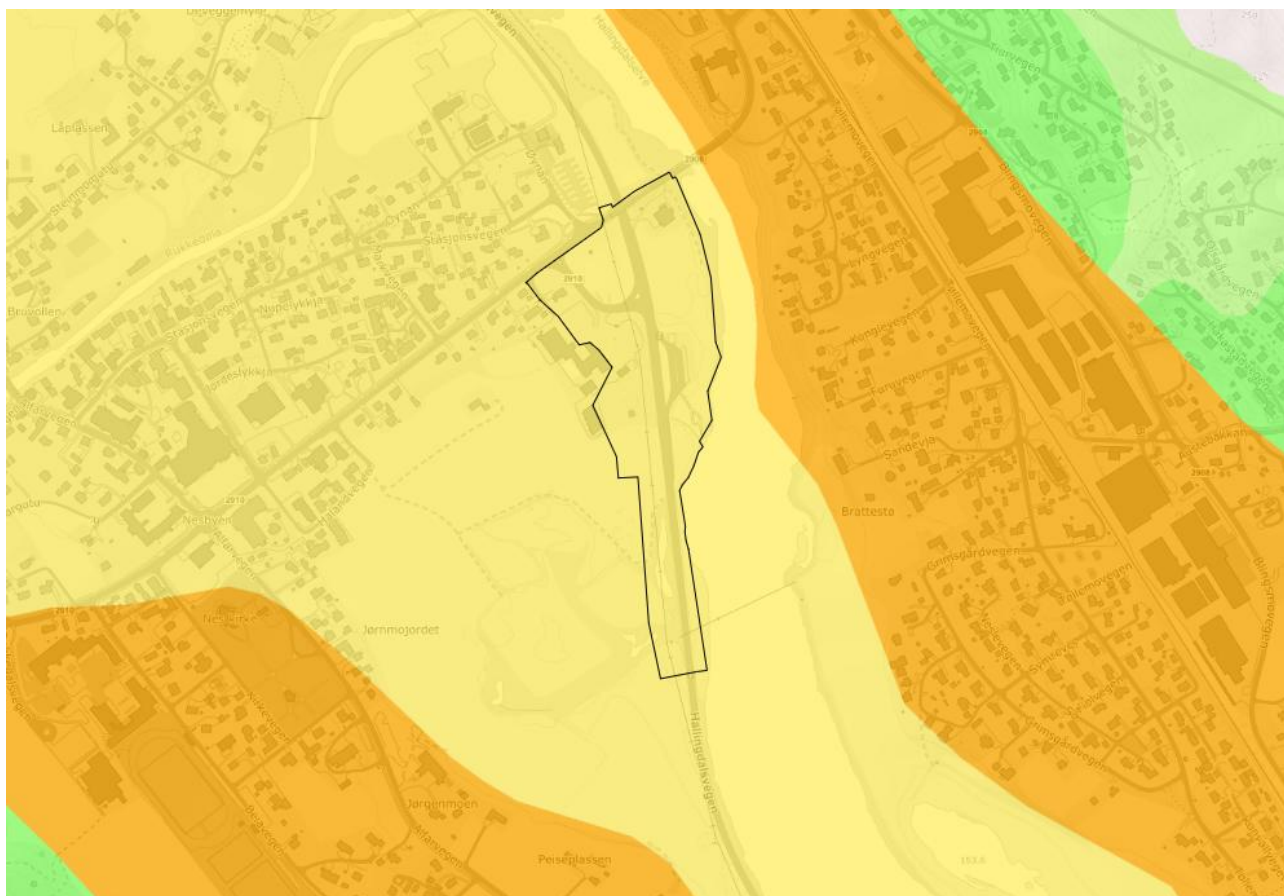
Figur 8. Kartutsnittet viser løsmasser og grusressurser. Gul farge viser Elve- og bekkeavsetninger og orange farge viser Breelvavsetninger. Kilde: Kilden
